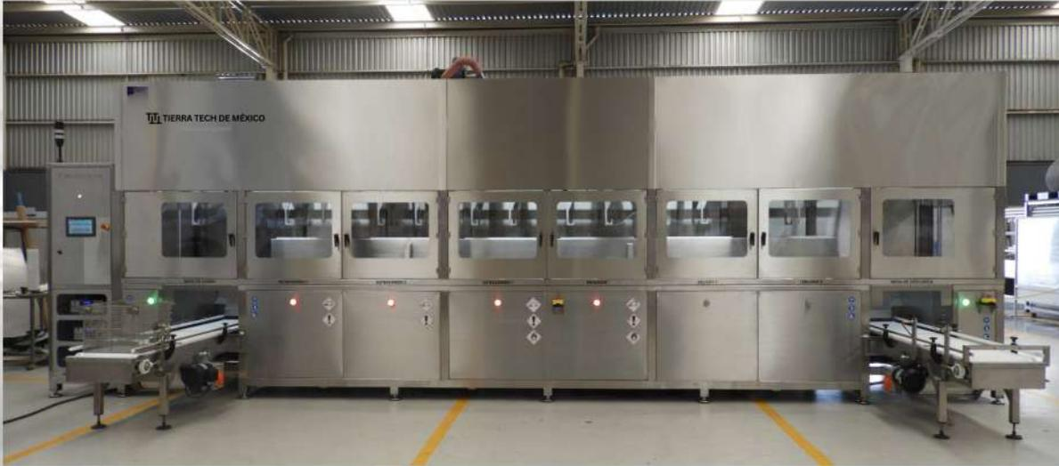
*Equipo multi-etapa automático de 150 litros de capacidad cada una diseñado para la limpieza de piezas de motores.*
