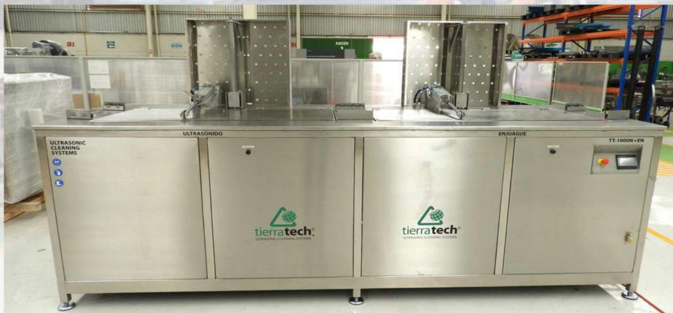
Equipo multicuba de limpieza por ultrasonidos fabricado por Tierra Tech De México para Macimex. El equipo consta de una tina de ultrasonido con sistema de recolección de residuos metálicos con sistema de filtrado y una segunda tina de enjuague por microburbuja.
