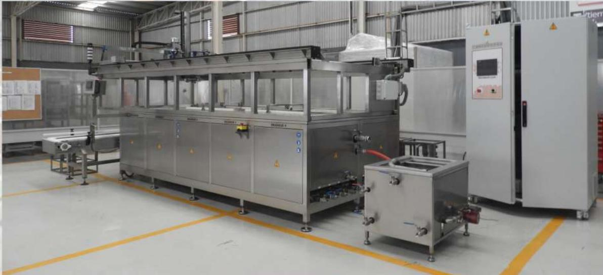
*Equipo multi-etapa automático de 150 litros de capacidad cada una diseñado para la limpieza de resortes metálicos.*
