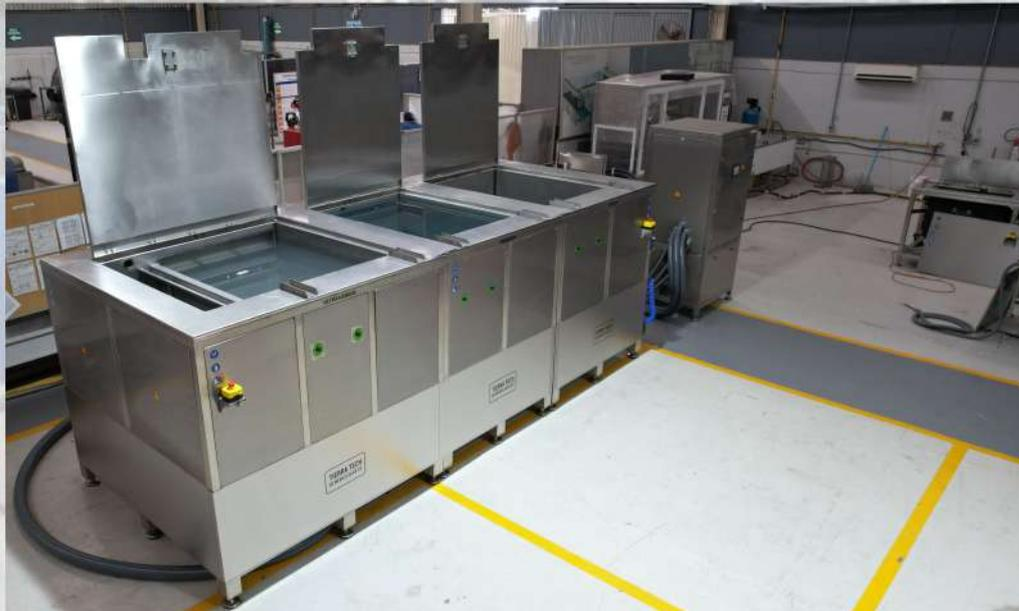
*Equipo multi-etapa automático de 3 cubas de 4000 litros de capacidad cada una diseñado para la limpieza de piezas de moldes de inyección de plástico .*
