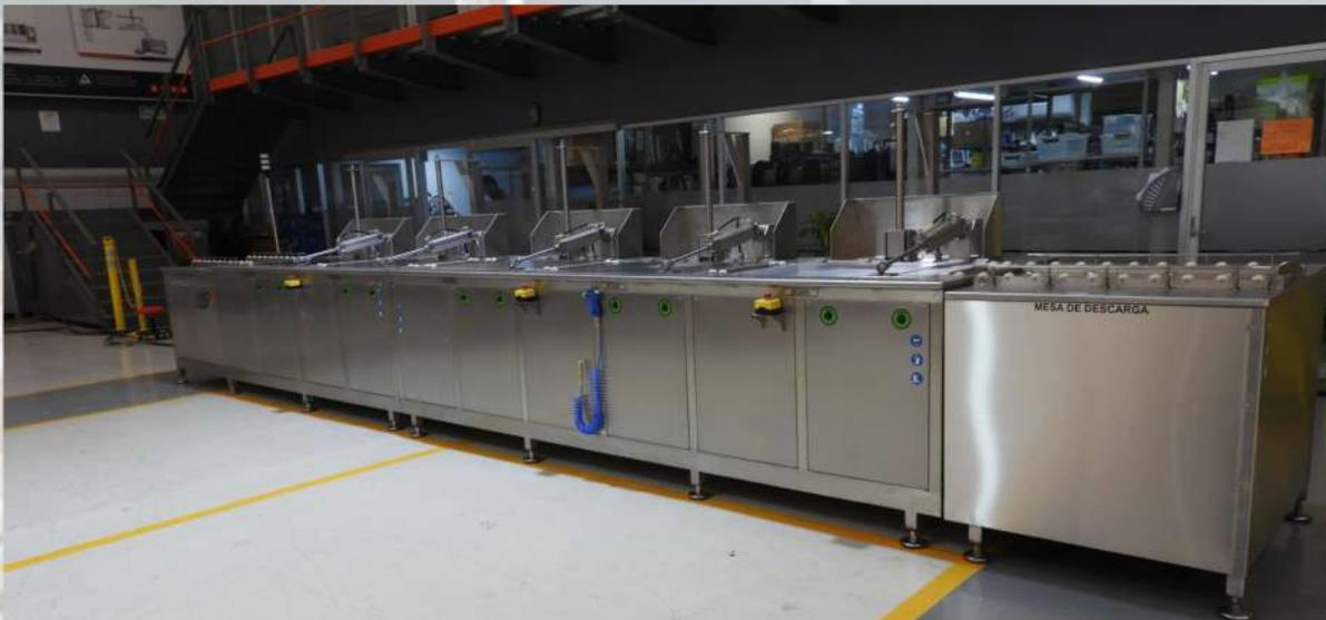
*Equipo multi-etapa automático de 300 litros de capacidad cada una diseñado para la limpieza , para lavar piezas de aluminio o metal estampadas.*
