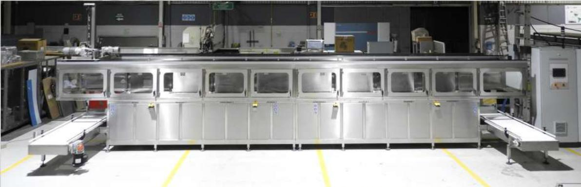
*Equipo multi-etapa de 150 litros para lavado sistemas de transmisión de motor y repuestos para aplicaciones automotrices .*
