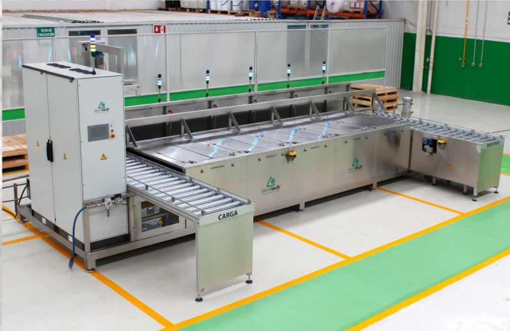
*Equipo multi-etapa automático de 6 cubas de 600 litros de capacidad cada una diseñado para la limpieza de piezas de aluminio y otras piezas metálicas.*
